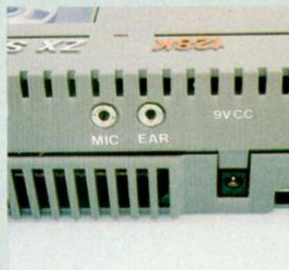
Aspecto de los Jacks hembra para el acceso de un cassette o cualquier otro dispositivo desde el exterior al ordenador.
